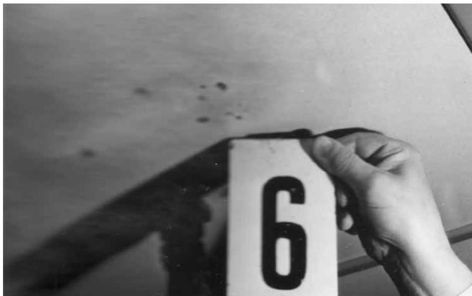
Obr. 24: Prostřelený umakart obložený střechy autobusu po výstřelu z Beňova revolveru. Z fotografie plyne, že Beňovy projektily nebyly příliš účinné, zřejmě je roztrhla expanze plynů bezprostředně po zážehu. Z hlavně tak nevylétla jednotná střela, ale její fragmenty, které sotva prostřelily umakart.
