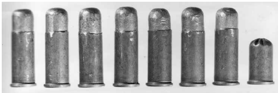
Obr. 10: Náboje do Beňova revolveru. Zcela vpravo je náboj do jateční pistole v původní podobě. Beňo do ostatních vložil projektily, které odlil z broků do vzduchovky.
