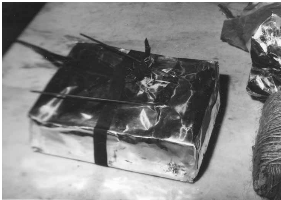
Obr. 5: Detailní pohled na jednu z náloží. Měla tvar krabice o rozměrech 26 \times 22 \times 8 cm, byla zabalená v alobalu a omotaná izolační páskou. Účelem drátů ve tvaru V bylo působit psychologicky .
