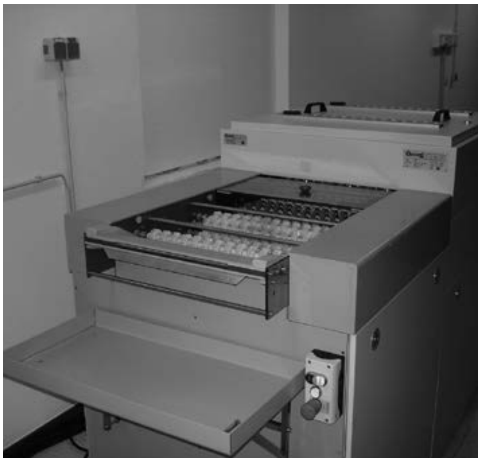
Neschen C 500 – přístroj na hromadné odkyselování archiválií
